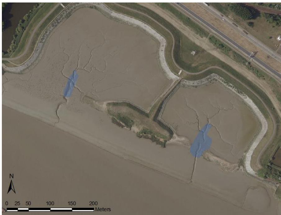
Figuur 3: Estuarien herstel in Potpolder Lillo: situatie 2015 met in blauw de in 2012 uitgegraven bressen en overdieptes.
