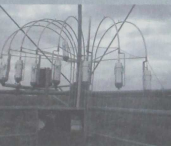
Meting van de concentraties van gasvormig ammoniak en ammoniumaërosol door middel van de combinatie honing-raatdenuder-filterpack
