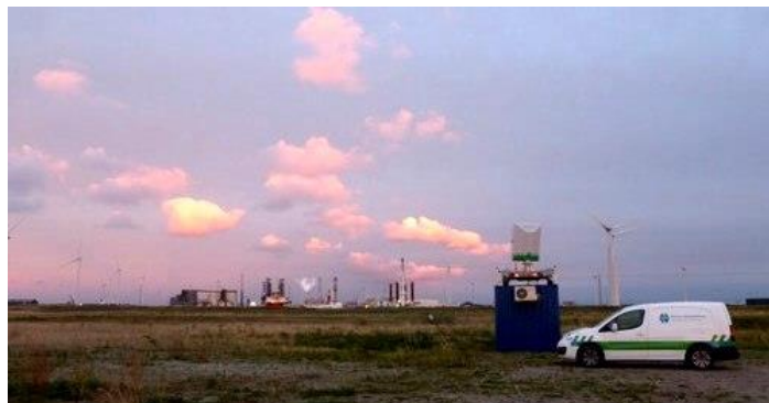
Figuur 5. Vogelradar aan het Eemshaven windpark (Bureau Waardenburg)
