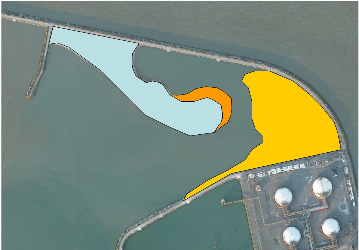
Figuur 1. Schematische voorstelling van de ligging het huidige Sternenschiereiland te Zeebrugge (in licht blauw) en de geplande bijkomende opspuitingen (in oranje)
