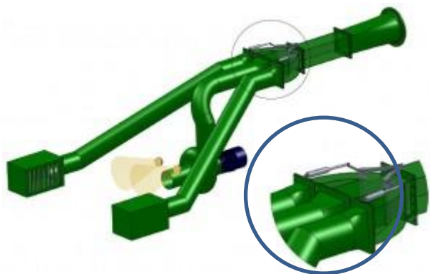
Figuur 5 - Werking van de gemaalvispassage. De pomp bevindt zich centraal tussen de twee inzwemopeningen en wordt afgeschermd door twee stroboscooplampen. Inzet: venturisysteem.
