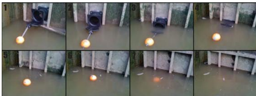
Figuur 7: Tweede type kattenluik. Mitigator Fish passage device (Nehalem Marine). De onderzijde van de klep scharniert op de hoofdklep en vlotters regelen de opening van het onderste deel. Een tandwielstelsel zorgt ervoor dat dit onderste deel geblokkeerd wordt in de open positie tijdens eb en het eerste deel van vloed. Tijdens de tweede helft van de vloed duwt het opkomende water de vlotters omhoog en wordt de blokkering van het onderste deel opgeheven, waardoor de klep volledig sluit.
