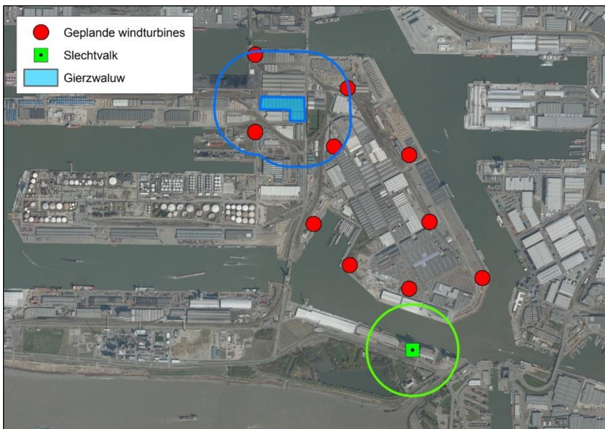
Figuur 2: situering van de geplande windturbines met weergave van de broedlocaties van slechtvalk en gierzwaluw, incl. een risicozone van 300 m rondom deze locaties.
