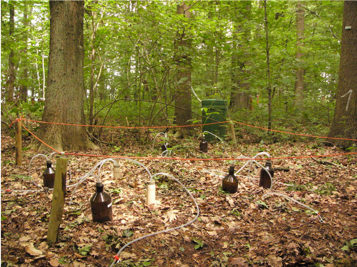
Fig. 1 Lysimeters in het Level II proefvlak te Gontrode.
